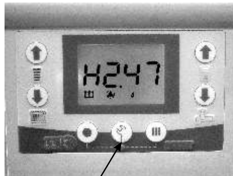
Короткое нажатие - переход между неисправностями, 2 - обозначает номер неисправности, 47 - код неисправности.
