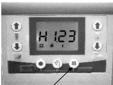
Вход в режим архива поломок нажатием кнопки С более 3 сек. Первой отображается неисправность обоз. Н1; 23 - код неисправности.
